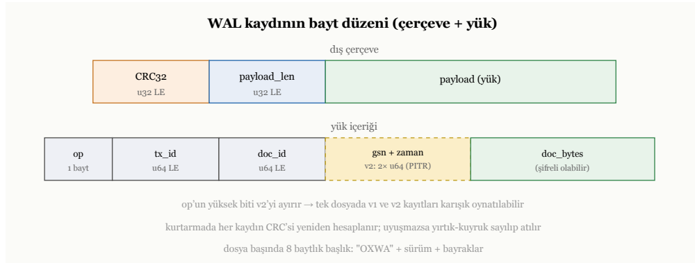
Şekil 17.2: WAL kaydının bayt düzeni.
