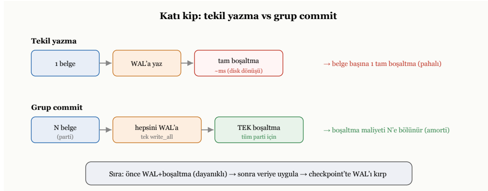
Şekil 17.3: Katı kipte tekil yazma ile grup commit'in karşılaştırması.
